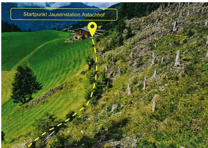
Abbildung 10: Skizzierter Verlauf der geplanten Radwegtrasse über die steile Weide im Bereich der Jausenstation Astachhof
